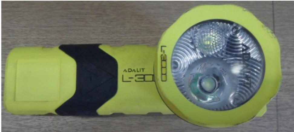
Ende März kam es am LF 20 Kats der FF Fiedrichshagen zu einem technischen Zwischenfall. **Aus bisher ungeklärten Umständen entwickelte der Akku einer Handlampe vom Typ Adalit L 3000 soviel Wärme, dass es zum Verschmelzen der Lampe kam.** Glücklicherweise wurde der Zwischenfall durch einen anwesenden Kameraden frühzeitig erkannt, so dass ein größerer Schaden abgewendet werden konnte.
